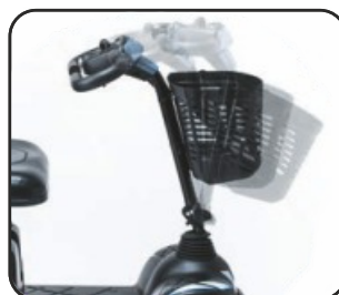
Columna de conducción
